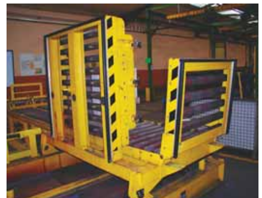
Bordi ↪ su paratie mobili ribaltabili
