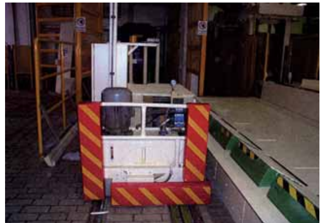
Fig. 12 - Bumper SSZ per protezione carrelli
