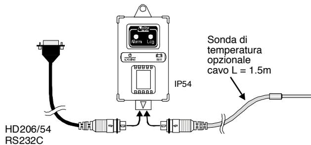
HD206-2 Sonda di temperatura ed umidità relativa
