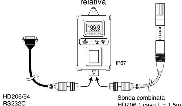
HD226-2 Sensore di temperatura interno e sonda combinata temp/umidità esterna a filo
