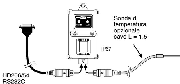
HD207-1 Sensore di temperatura esterno
