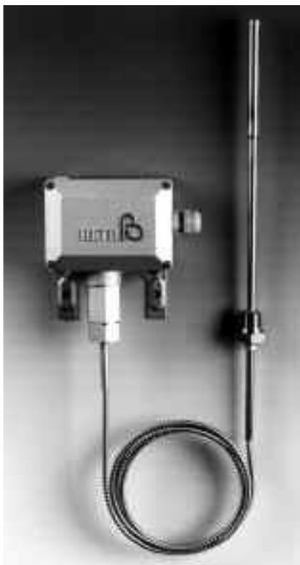
Il termostato BETA è costituito da un pressostato, collegato ad un sensore di temperatura a fluido bi-fase (gas/liquido). Quando la temperatura del processo aumenta, anche la pressione del vapore del fluido aumenta. Se la pressione del vapore supera il punto di taratura del "pressostato", questo attuerà l'interruttore.
